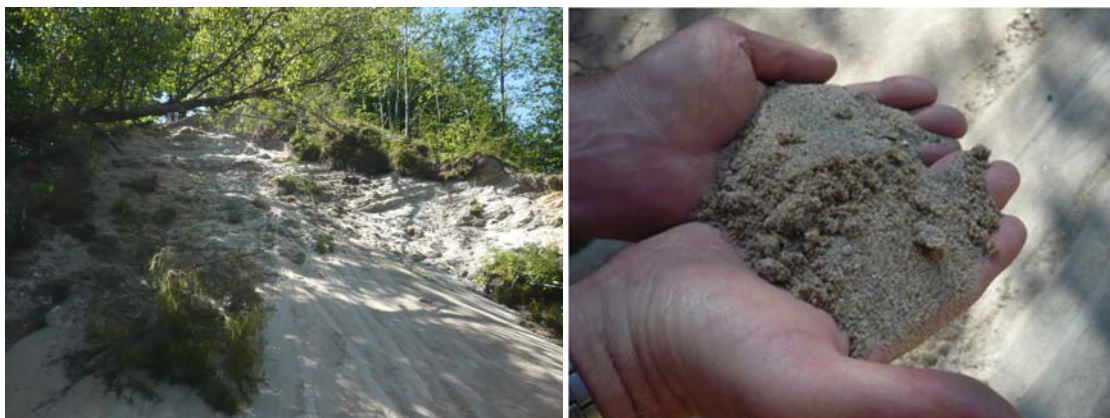
Figur 12. Viser naturlig rasskråning dominert av fin sand i terrasse-skrenten litt nord for overvåkingsbrønnen.
