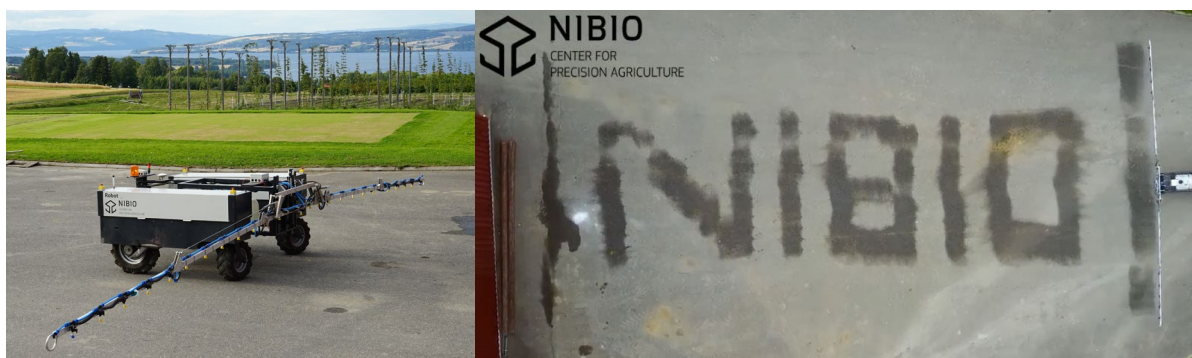
Bilde 2: Robotti med eksaktgjødslere (t.v.) og demogjødsling (t.h.). Foto: Maximillian Pircher
