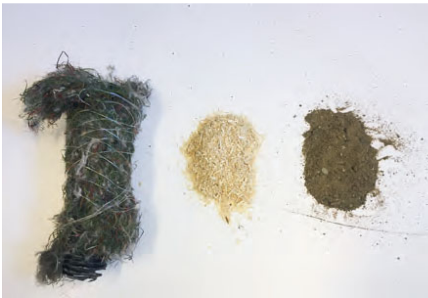
Bilde 1: Filtermaterialene som er brukt hos Bjørn Lund; Prewrap PP700, sagflis og grus.
