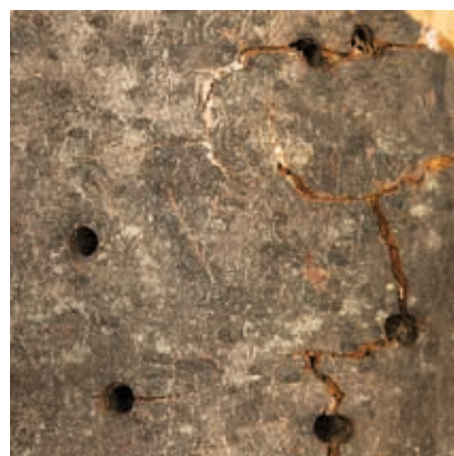
Runde utgangshull - I motsetning til de fleste vedlevende billene har treveps helt runde flyvehull. Foto: Dan Aamlid/© Skog og landskap.
