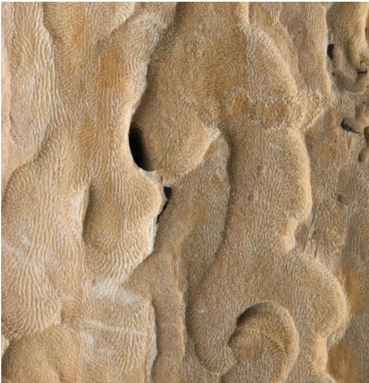
En god treskjærer: Slik ser det ut når blåbukkens larver har fått gnage i lang tid. Foto: Dan Aamlid/© Skog og landskap.
