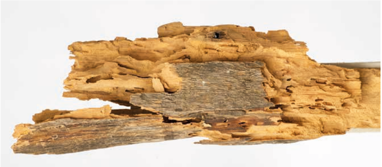
Lite igjen: Når husbukkens larver får gnage uforstyrret i lang tid blir det lite annet enn støv igjen av treverket. Fet kjerneved av furu ødelegges lite av husbukk. Foto Dan Aamlid/© Skog og landskap.
