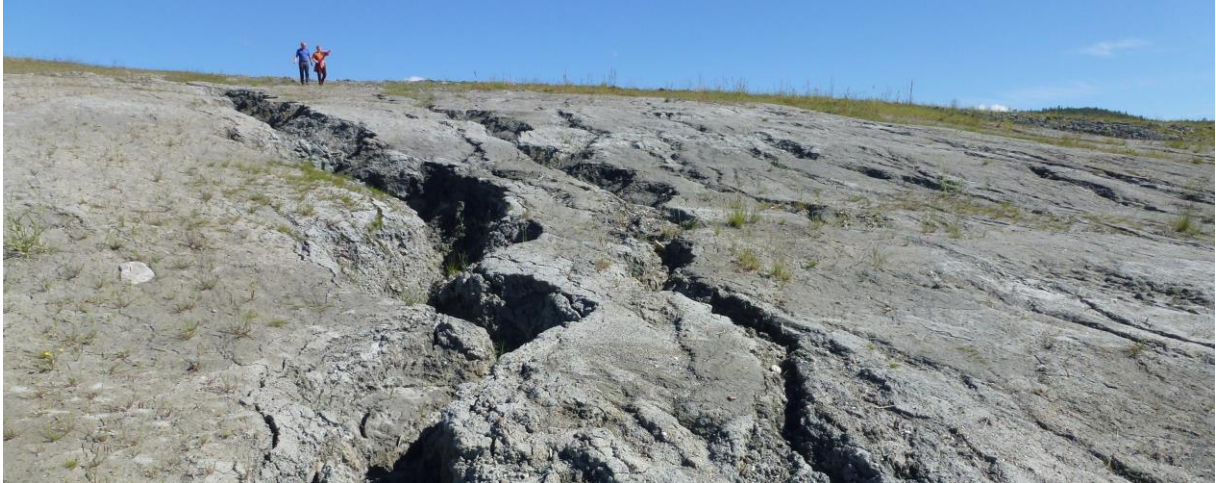
Figur 11. Bildet viser påfylt område som ikke kan klassifiseres som jordbruksareal. De påfylte massene består for det meste av massiv leire uten jordstruktur, og har ikke matjordlag. (Grong)
