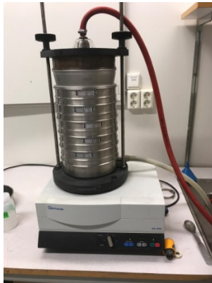
Figur 2. Siktemaskin hos NIBIO som bruker vann og vibrasjon til å fraksjonere fast materiale i bløtgjødsele i ulike partikkelstørrelser
