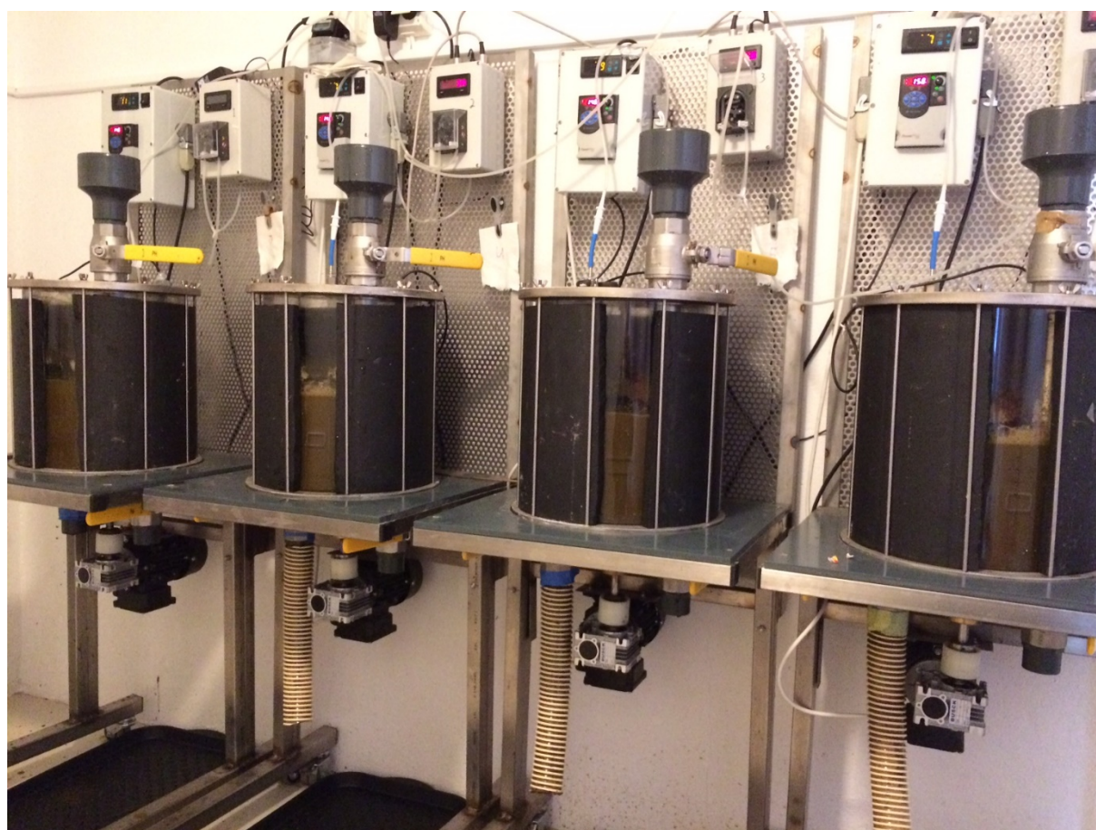
Figur 4. Biogassreaktorer med, fra venstre, behandlet, ubehandlet, behandlet og ubehandlet gjødsel, kort tid etter at gjødselen ble tilsatt. Merk betydelig kraftigere skumming i ubehandlet gjødsel, noe som indikerer biologisk aktivitet og gassproduksjon. Foto: Joshua Cabell, NIBIO.
