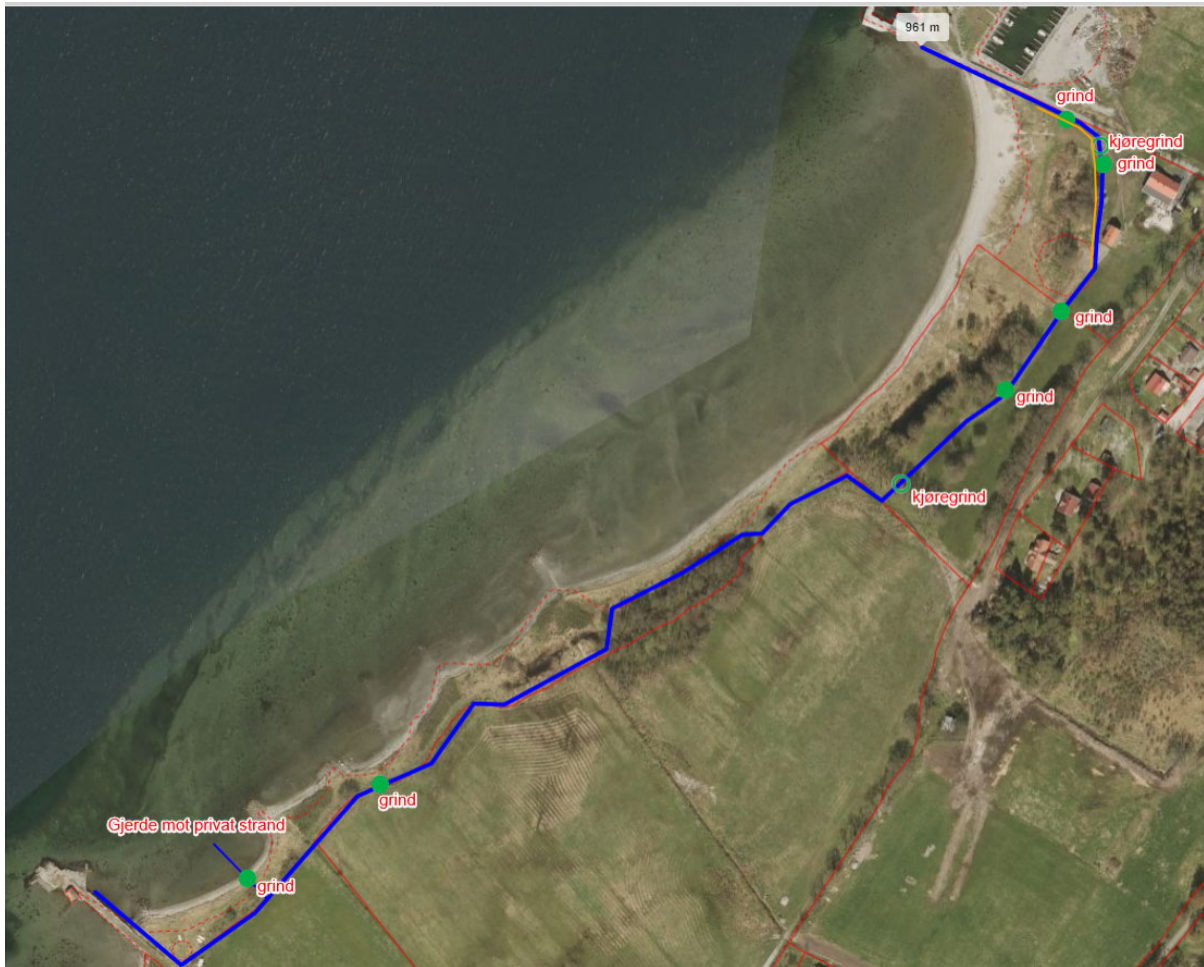
Figur 34. Flybilde med inntegnet plassering av fastgjerde, blå strek, totalt ca 960 m. Grønne punkter viser ca angivelse av grinder. Det anbefales å lage et par breie grinder hvor det kan passere traktor, ev større maskiner. Gul tynn strek langs gjerdet i nord viser felt hvor det kan være aktuelt å forsterke gjerdet med et bord på toppen. Dette pga stor ferdsel i friområdet. Kart: www.gardskart.no
