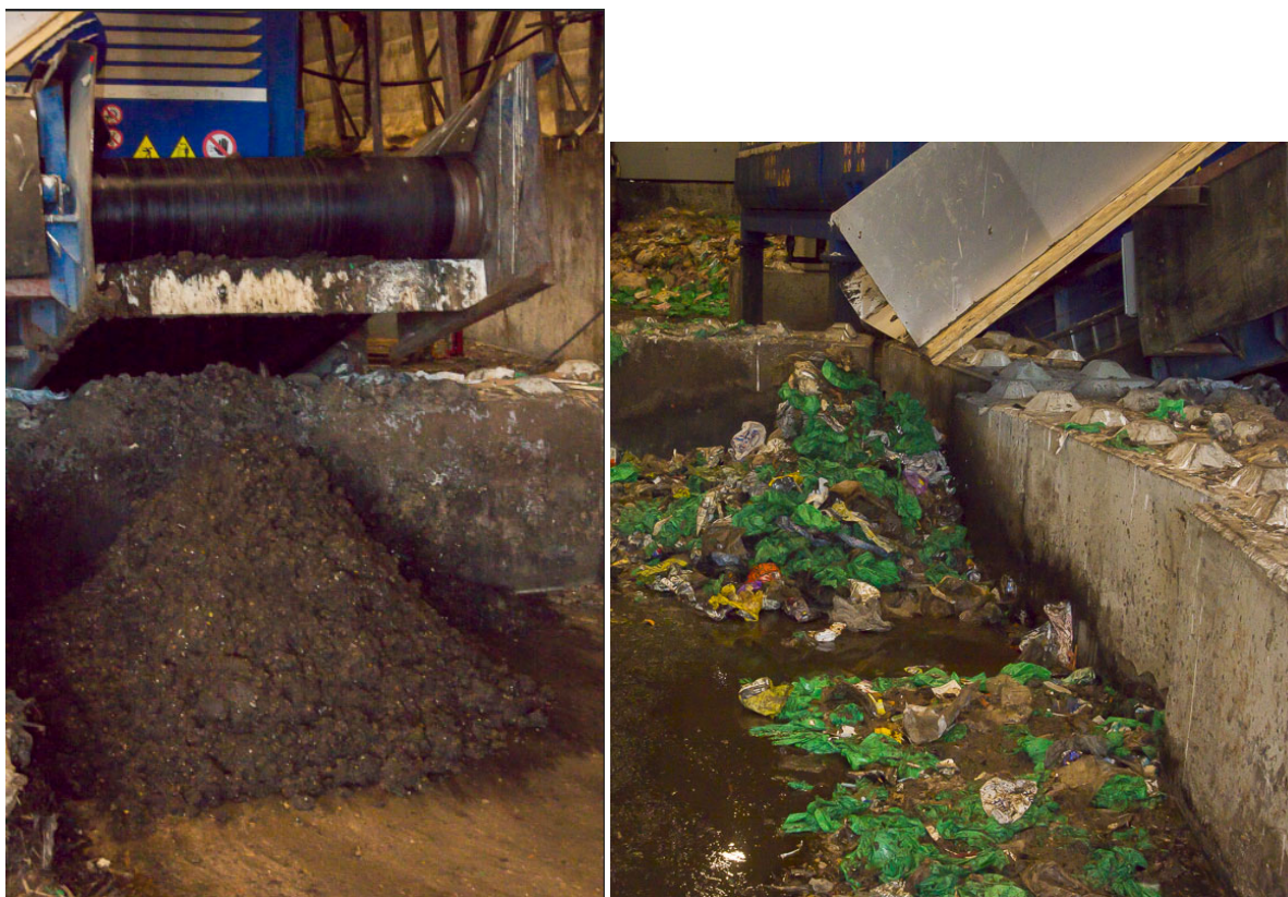
Figur 7. Forbehandlet matavfall til venstre og utsortert rester av plast og plastposer til høyre.
