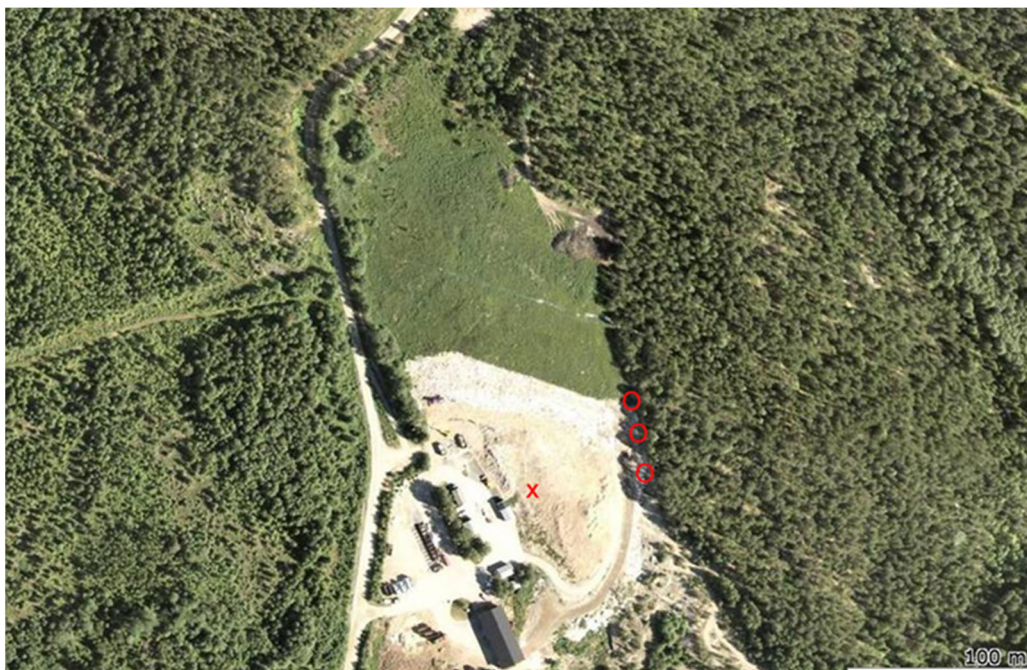
Figur 1. Flyfoto over deponiet på Spillhaug. Kryss viser området hvor det ble målt gass i fluksammer tidligere 2012 og 2013. Åpne ringer viser hvor måling i 2014 og 2015 er blitt utført og hvor de døde trær sto før de ble fjernet.
