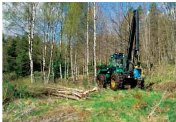
Figur 6 Timberjack 870 med Abab Klippen 250 og HSP gripen.
