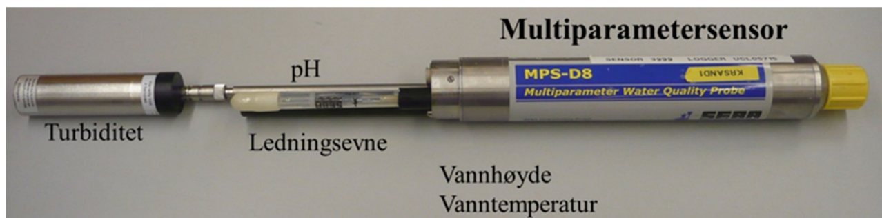
Figur 5. Multiparametersensor for automatisk overvåking av vannkvalitet.
