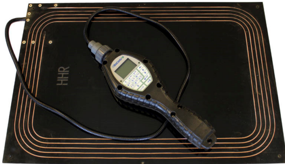
Figur 9. Håndholdt avleser med plateantenne levert av Biocontrol AS/OS id
