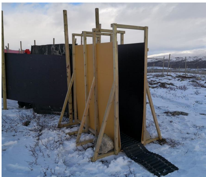
Figur 19. T.v: Mobil sluse med plateantenne, Helligskogen RBD. T. h.: Plateantenne med avleser ferdig oppmontert på sluse, Rakkonjarga RBD (foto: Erlend Winje)
