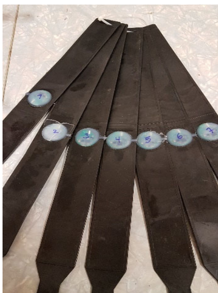
Figur 20. Små radiosendere støpt inn i et plathalsbånd til rein. Disse senderne brukes til varslingsystem for rein langs vei (foto: Grete Jørgensen)
