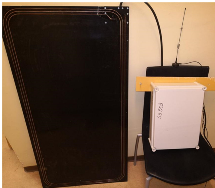
Figur 18. Stasjonær avleser (t.h.) med panelantenne (t.v.) fra Biocontrol AS (foto: Erlend Winje)
