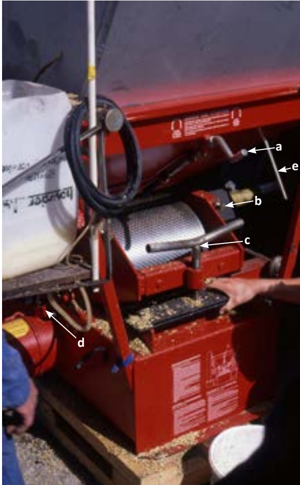
Moglegheiter for innstilling av: a) mateluka b) valseavstanden (grovjustering, begge sider av maskina) c) valsetrykket d) tilførsel av ensileringsmiddel og vatn e) valseavstand (finjustering). Utforminga kan variere med modell. Foto: Matthias Koesling.
