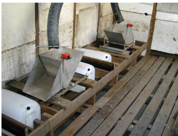
Figur 2-5. Venstre bilde: Oppsamlingsrenne for overflateavrenning. Målehytte i bakgrunnen. Høyre bilde: innsiden av målehytta med vippekar for vannføringsmåling og plastkanner for oppsamling av vannprøver. Foto: R.M. Skjevdal.
