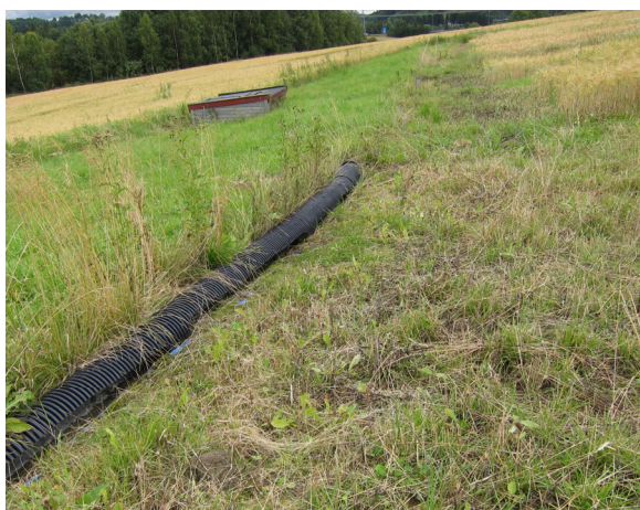
Figur 2-5. Venstre bilde: Oppsamlingsrenne for overflateavrenning. Målehytte i bakgrunnen. Høyre bilde: innsiden av målehytta med vippekar for vannføringsmåling og plastkanner for oppsamling av vannprøver. Foto: R.M. Skjevdal.
