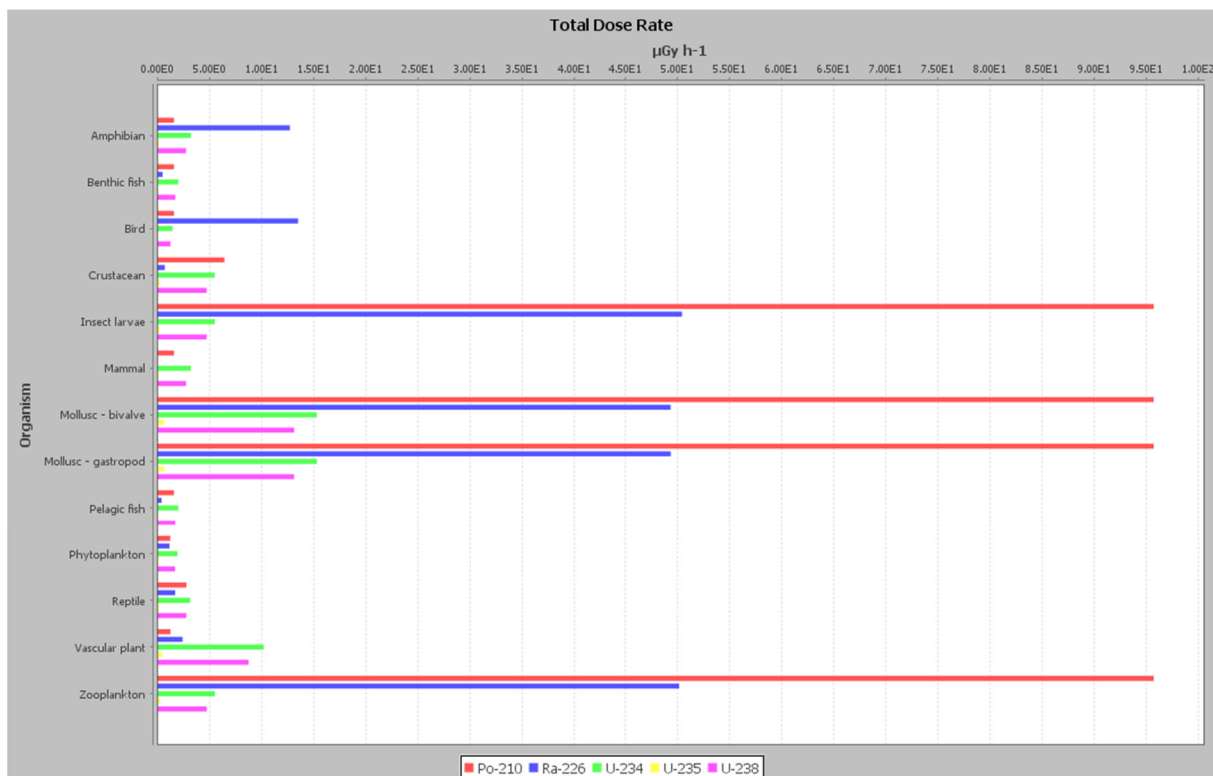
Figur 36: Doserate estimert for de ulike referanseorganismene fra gitte radionuklider beregnet med ERICA Assessment Tool. Beregnet bidrag til doserater er størst for 226 Ra og 210 Po, mens det er mindre for uranisotopene.
