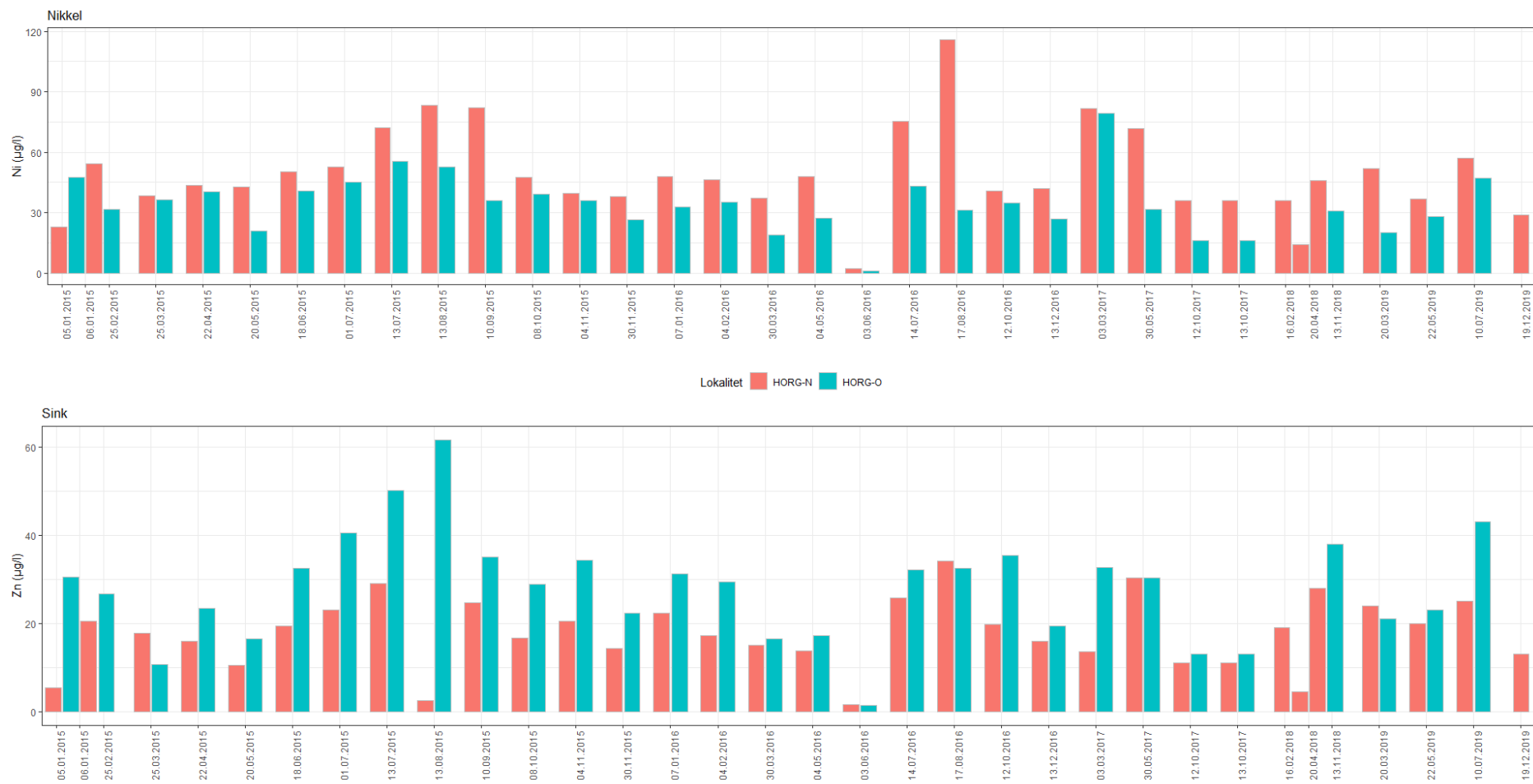
Figur 41. Nikkel og sink i Horgenbekken gjennom anleggsperioden 2015-2016 og etter ferdigstilling av veien 2017-2020.
