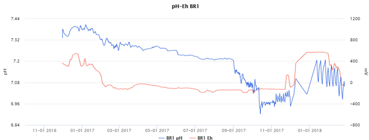
Figur. Kontinuerlige målinger av pH og redoks i grunnvannsbrønn B1 gjort av Geonor i perioden januar 2016-mars 2018.
