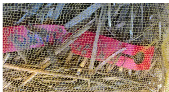
Bilde 3. Nettposer for måling av halmens nedbryting. Foto: Till Seehusen.
