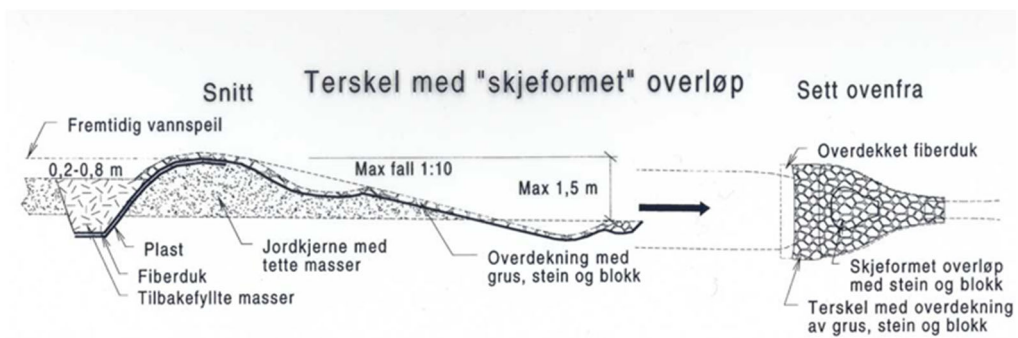
Figur 16. Prinsipptegning for skjeformet utløp.
