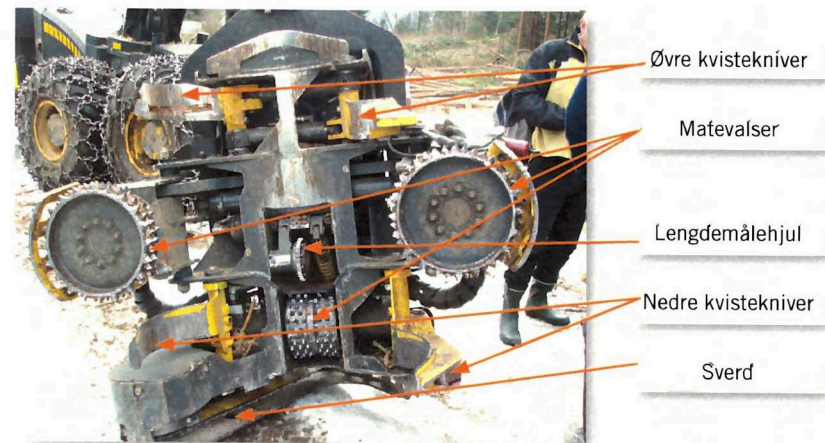
Figur 14. Ponsse H8-aggregat med opparbeidings- og måleustyr. Foto: Terje Birkeland 2008.
