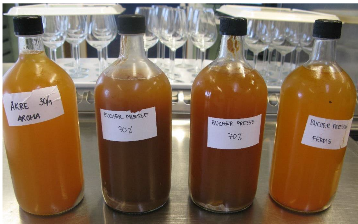
Figur 4-5. Bilete av juice pressa med beltepresse (venstre) og 3 prøvar under presseprosessen med Bücherpresse (30%, 70% og ferdig pressa). Foto: Mats Carlehög.
