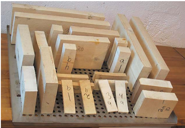
Hysteresis: Prøvebiter av forskjellig lengde, kvalitet og utgangsfuktighet. Foto: Peder Gjerdrum
