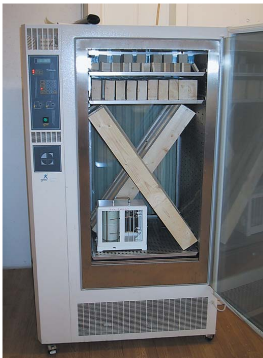
Prøvebiter av varierende lengde i klimaskap for analyse av størrelsens betydning for likevektsfuktighet. Foto: Peder Gjerdrum
