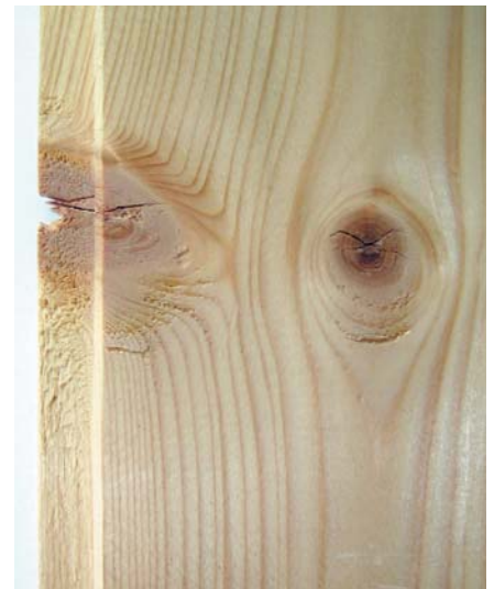
Fibrene avbøyes i et tredimensjonalt mønster rundt kvister. Dette påvirker overflatens glans, årringmønster, absorpsjon av f.eks. beis, utrevne fiber og styrke.
