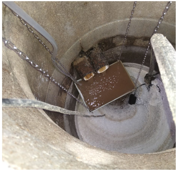
Figur 2.2. Prøvekar med langt prøvetakerrør (venstre bilde) etablert i kummen der vaskevannet renner inn og tilsvarende bilde (høyre) under prøvetakingen (foto: Isak Drozdik)
