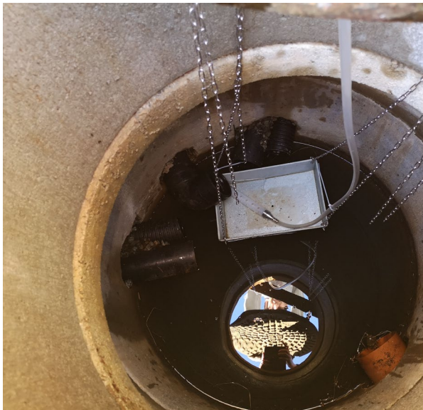
Figur 2.2. Prøvekar med langt prøvetakerrør (venstre bilde) etablert i kummen der vaskevannet renner inn og tilsvarende bilde (høyre) under prøvetakingen (foto: Isak Drozdik)
