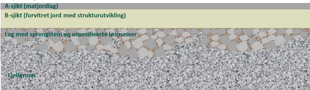
Figur 12. Prinsippkisse for oppbygging av jordsmonn til jordbruksareal (fra Hauge & Haraldsen 2017).
