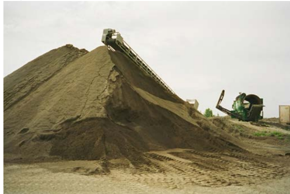
Figur 12. Tillaging av forblandinger for produksjon av anleggsjord basert på naturlige jordmasser av sand, siltig sand, lettleire, steinmel og avvannet torv (Foto: Trond Knapp Haraldsen).
