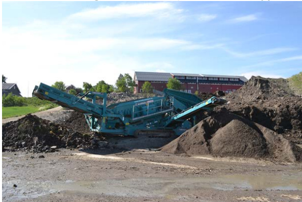
Figur 12. Tillaging av forblandinger for produksjon av anleggsjord basert på naturlige jordmasser av sand, siltig sand, lettleire, steinmel og avvannet torv (Foto: Trond Knapp Haraldsen).
