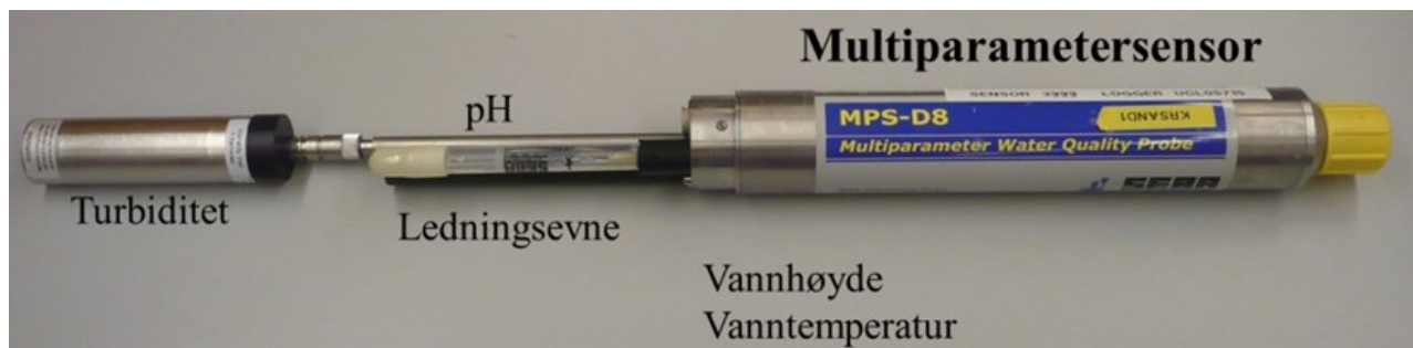
Figur 3. Multiparametersensor for kontinuerlig overvåking av vannkvalitet.
