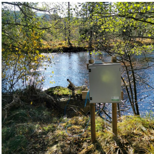
Figur 8. Plassering av kontinuerlig måleutstyr til overvåking av vannkvalitet ved nedstrømsstasjon 1 i Hovlandsåna (HOV_NED1).
