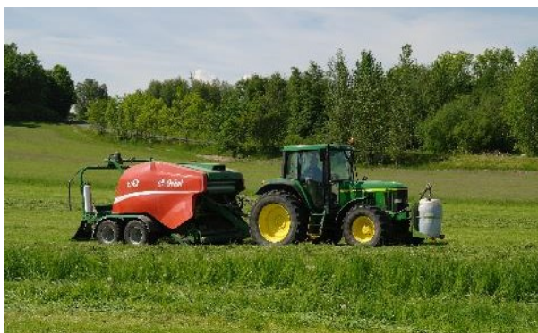
Bilde. 'Standard'-haustesystem der grasnet blir slått med breispriarslåmaskin med crimper (venstre, foto: Jan K. Henriksen), fortørka, raka saman med ei rive og samla opp, pressa og pakka inn i plastikk med ei kombipresse (høgre, foto: Åshild T. Randby)
