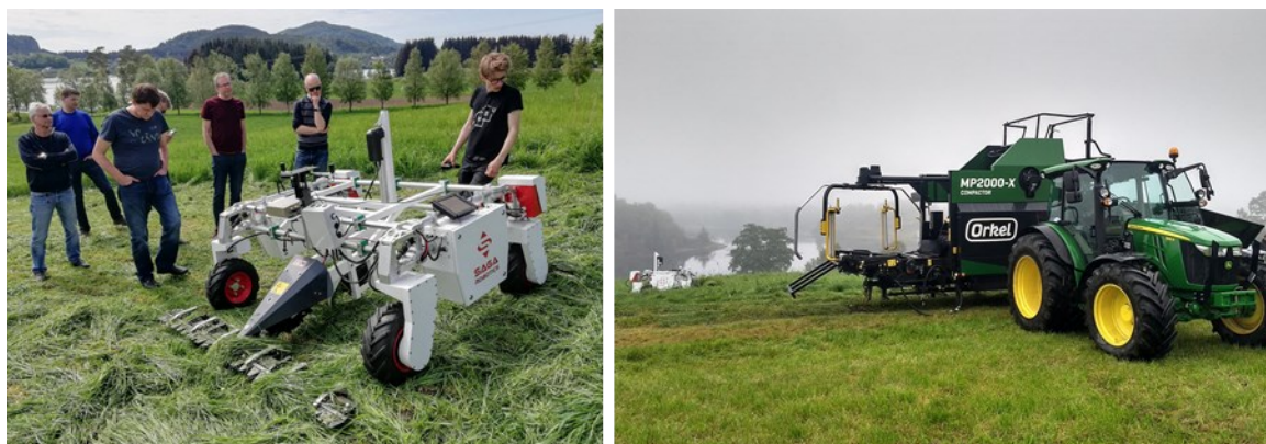
Bilde 1. 'Robot'-haustesystem der graset blir slått med sjølvgåande robot med knivbjelke (venstre, Foto: Synnøve Rivedal), fortørka, raka saman med ei rive og samla opp og transportert med sjølvgåande robot til stasjonær rundballepresse der graset blir pressa og pakka inn i plastikk (høgre, Foto: ©NMBU)
