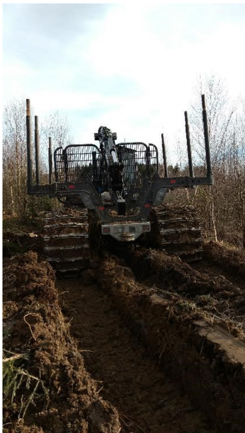
Figur 8. Noen steder er det generelt dårlig bæreevne. Det finnes en rekke aktuelle tiltak for å hindre slike kjøreskader. Her må traseen restaureres etter endt drift. Foto: Johannes Enersen, Romeriks Allmenningene .
