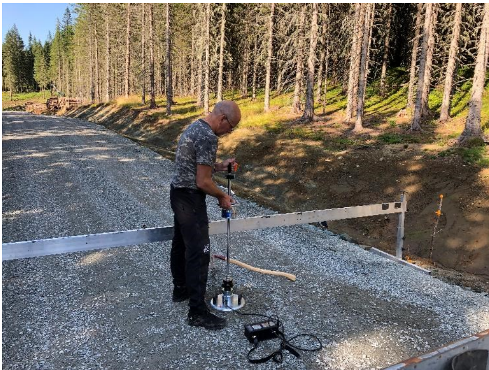
Bildetekst: Bæreevne måling utført av veiplanlegger Bjørn Arve Øvereng på en nyanlagt vei. En solid og fint utformet vei. Bilde: Martin Bråthen, Skogkurs.
