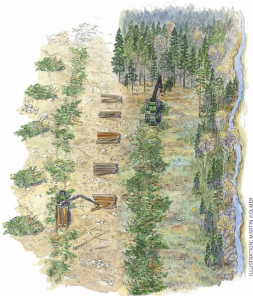
Figur 7. Illustrasjonen viser en kjøretrasé som bør brukes ved felling i nærheten av vann. Fordi både hogst og lassbærer bruker hele kranens rekkevidde, kan lassbæreren gå langt fra den våte kantsonen. I dette eksemplet kan lassbæreren kjøre på fastmark. Dette forhindrer kjøreskader. Kilde: Skogsstyrelsen
