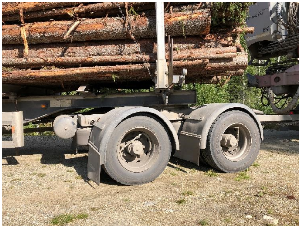
Figur 29. TPC - regulerer lufttrykket i dekkene. Lavere lufttrykk gir større overflate på veien, noe som reduserer marktrykket. Bilde: Martin Bråthen, Skogkurs.
