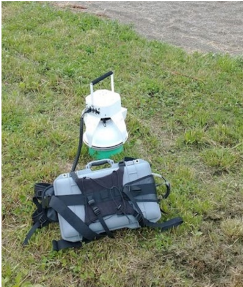
Figur 6: Flukskammer (i hvit) og gassanalysator (grå) brukt til å måle metan og CO 2 emisjon fra overflaten av nedlagt avfallsdeponi. Foto: Christian A. Schöpke
