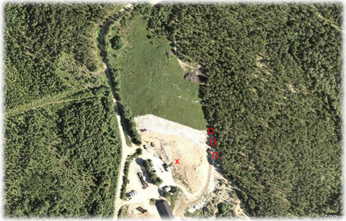
Figur 1. Flyfoto over deponiet på Spillhaug. Kryss viser området hvor det ble målt gass i fluksammer tidligere 2012 og 2013 Dette området er nå dekket til med god vegetasjon. Åpne ringe viser det utsatte området i kantsonen mot skog, hvor måling er blitt utført tidligere, men med mer nøyaktige måleutstyr i 2022. Foto: Ove Bergersen NIBIO.
