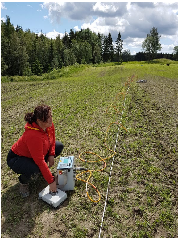
Bilde 5: Måling av elektrisk resistivitet. Foto: Esther Bloem
