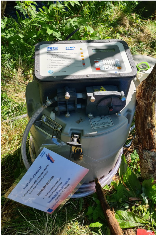
Figur 2. Automatisk vannprøvetaker benyttet i prosjektet.
