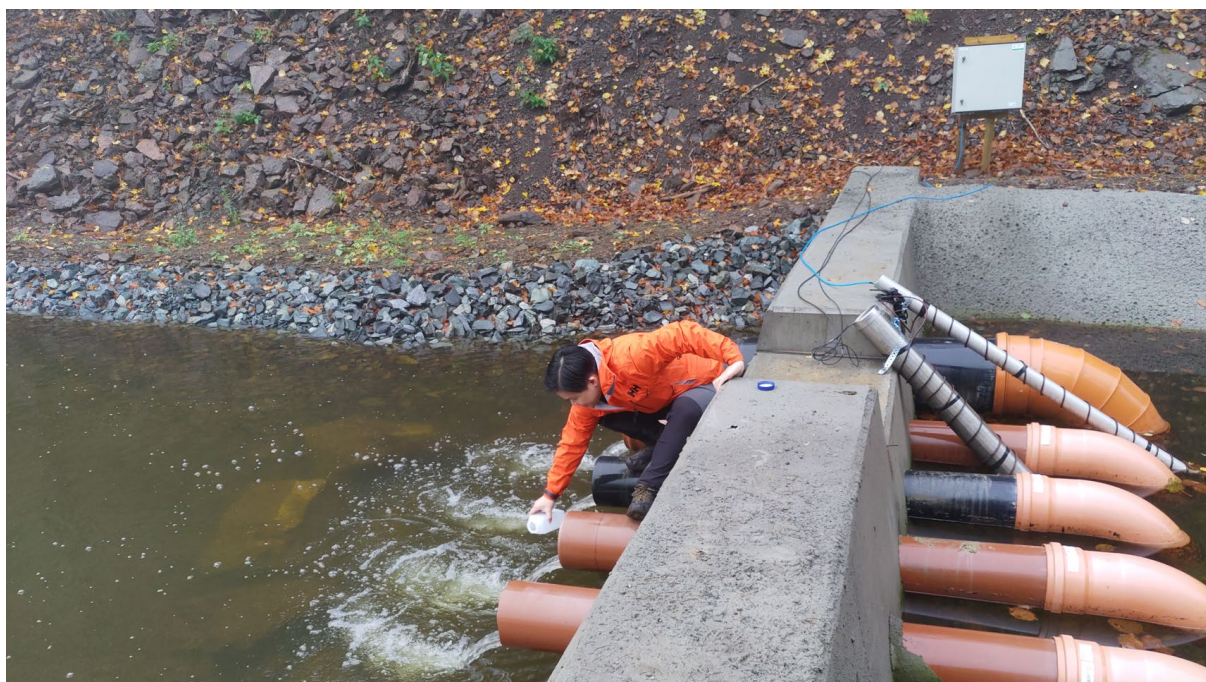
Figur 13. Stasjon INN med multiparametersonde (i tynt stålrør) og målinger av optisk nitrat (i grovt slisset stålrør). Masterstudent Manh-Tien Bui tar vannprøver.
