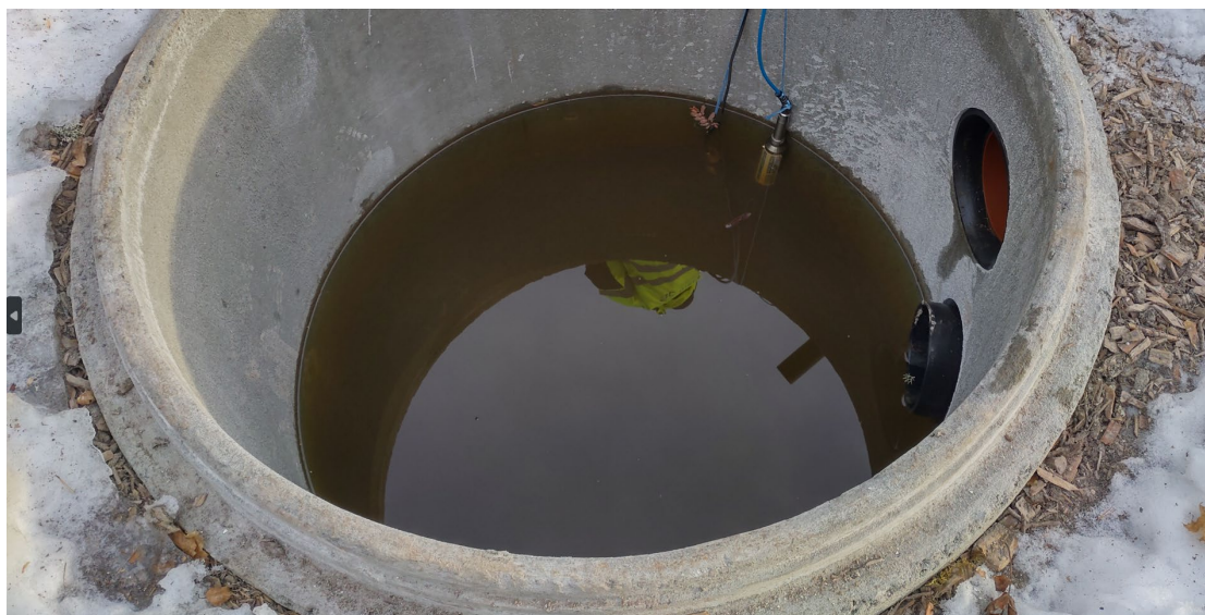
Figur 15. Plassering av multiparametersensor (til høyre) og optisk nitratsensor (til venstre) i utløpskum til F1 (F1 UT).
