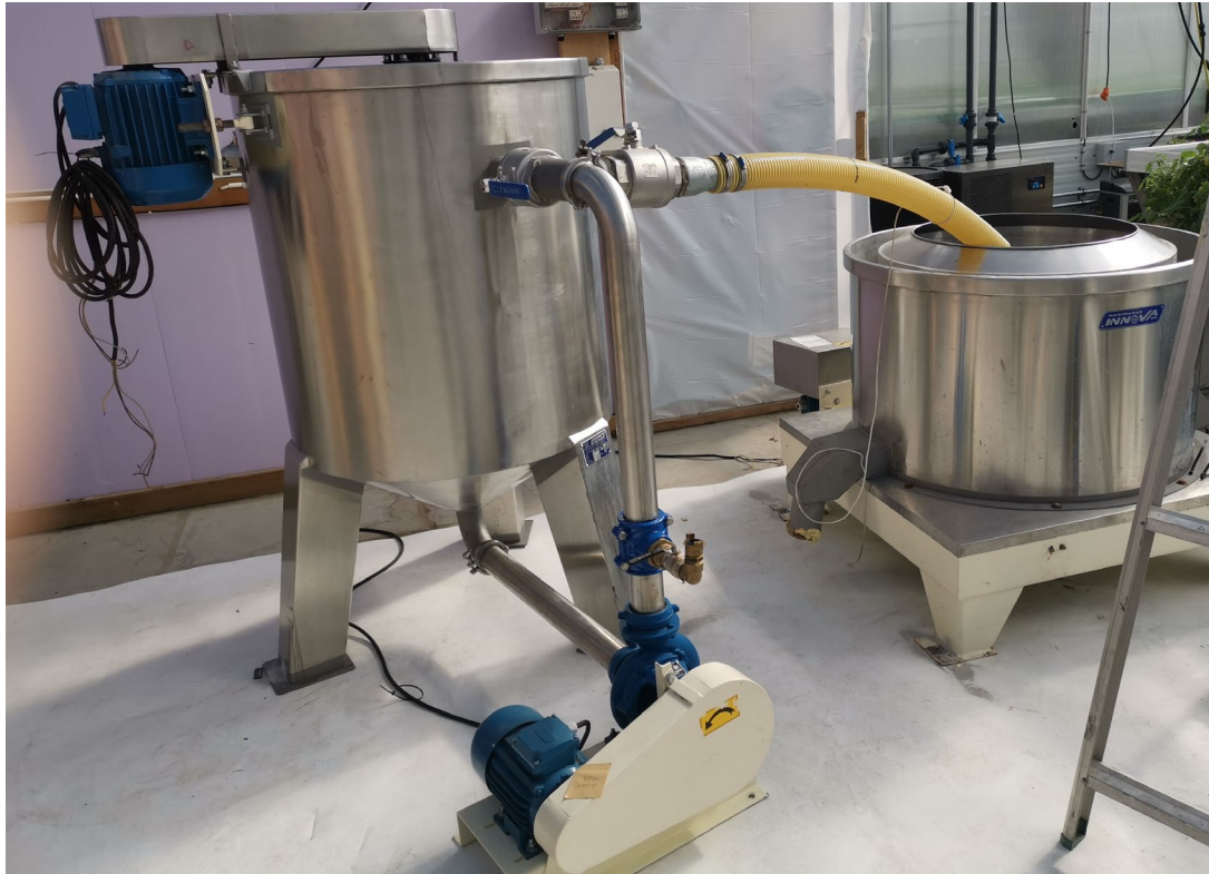
Bilde 4. Maskinell utvasking av aroniabær (ledd 3 og 4). Selve vaskemaskin, som er plassert til venstre, er koblet til en sentrifuge (til høyre). Foto: Lars T. Havstad.
