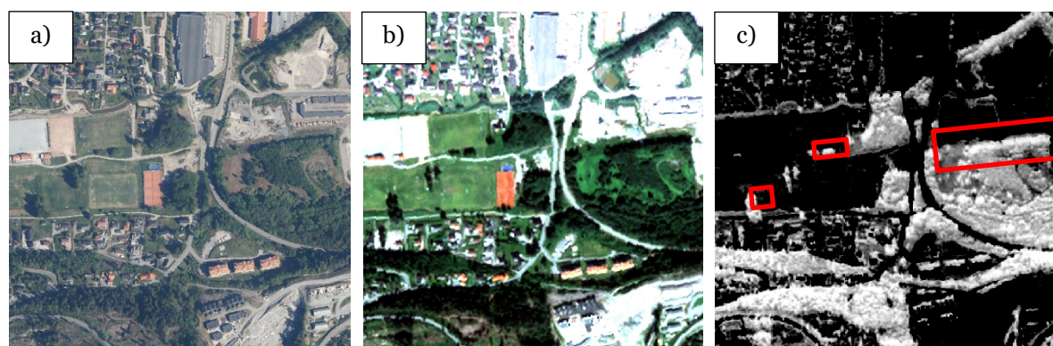
Figur 10: Eksempel fra Drammen som viser skyggelagt areal i et ortofoto og et VHR-satellittbilde. a) viser et ortofoto der vegetasjon og objekter på bakken kaster slagskygge mot nordvest. b) viser et VHR-satellittbilde med litt grovere romlig oppløsning. Allikevel blir slagskygge fra vegetasjon synlig på bakken. Ved sammenligning med ortofoto kastes slagskygge nå mot nord i bilde. c) viser den avledede NSVDI indeksen fra VHR-satellittbilde. De røde boksene markerer områdene der NSVDI-verdien er svært høy. Ved sammenligning med VHR-satellittbilde er de samme områdene skyggelagt. Sammenhengen kan brukes for å detektere skyggelagt areal.
