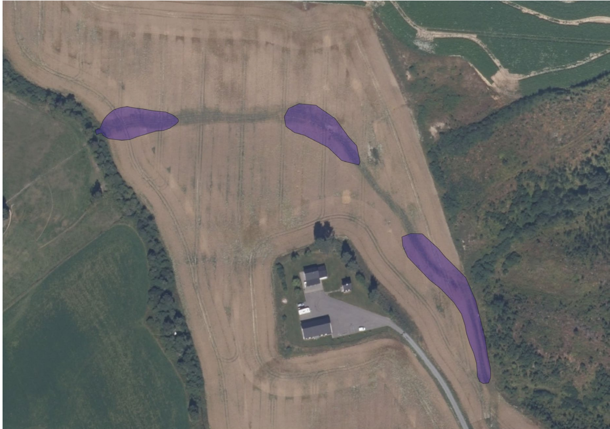
Figur 5. Flybilde med fangdamssystemet. Som kartet viser følger fangdammene et søkk i terrenget som naturlig fanger opp vannet som drenerer til Drogga (Flyfoto: ©kartverket).
