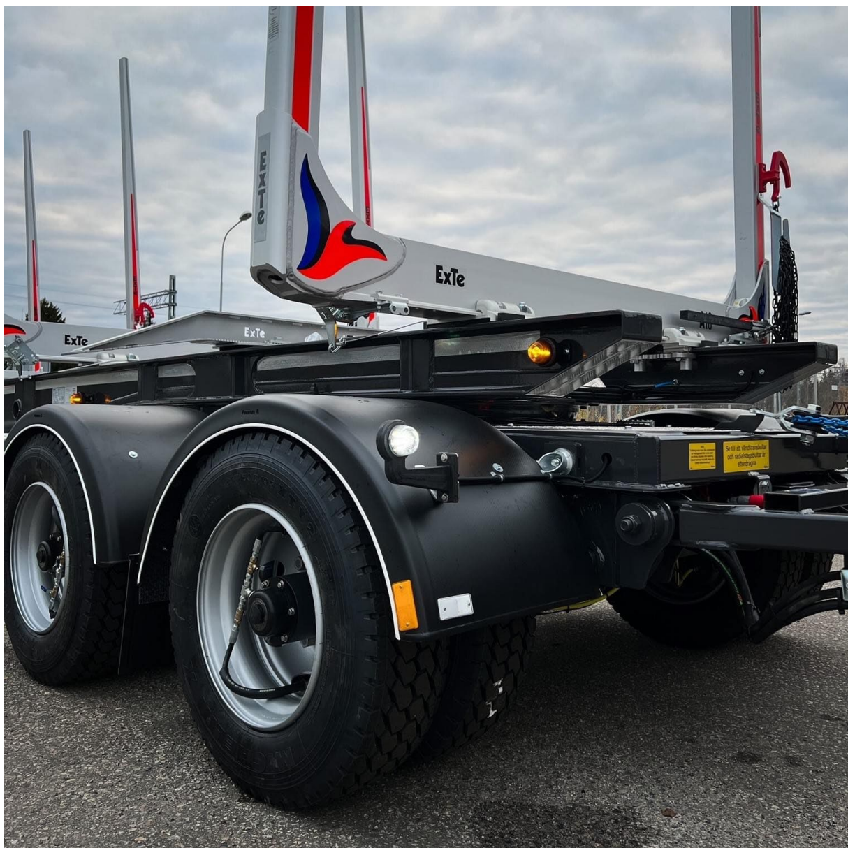
Figur 1. Dekktrykkregulering på hengerhjul. Trykkluftslangene går i hjulakselen til en svivel i enden av navet, og derfra ut til hjulene. Foto: Stig Sagmo, 2023.
