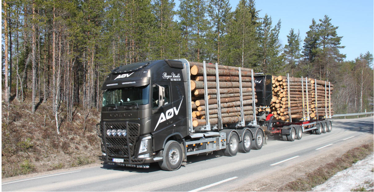
Figur 7. Tømmervogntog med 9 aksler og 74 tonns last. Her utnyttes lastevolumet fullt ut, men andelen av vogntogets vekt på drivhjulene vil være mindre enn med dagens 60-tonns vogntog. Derfor vil også fremkommeligheten trolig bli noe redusert. Dekktrykkregulering kan antagelig kompensere for dette. Foto: Dag Sjølås, skogeierforbundet.
