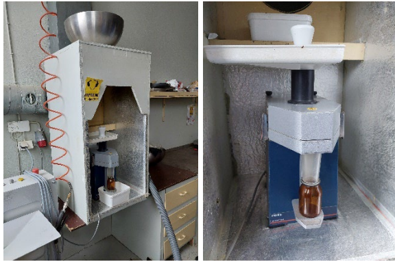
Figur 7. Cyclotec 1093 i punktavsugskasse på Særheim (ved å rengjøre med kraftig industristøvsuger i stedet for med trykkluft, så reduseres støy til omgivelsene betydelig!) Hos Graminor på Bjørke har de avsugskasse med avsugnet i bunn, slik at boss som havner utenfor suges bort. Foto: Nils Ragnar Stensø Skjørholm
