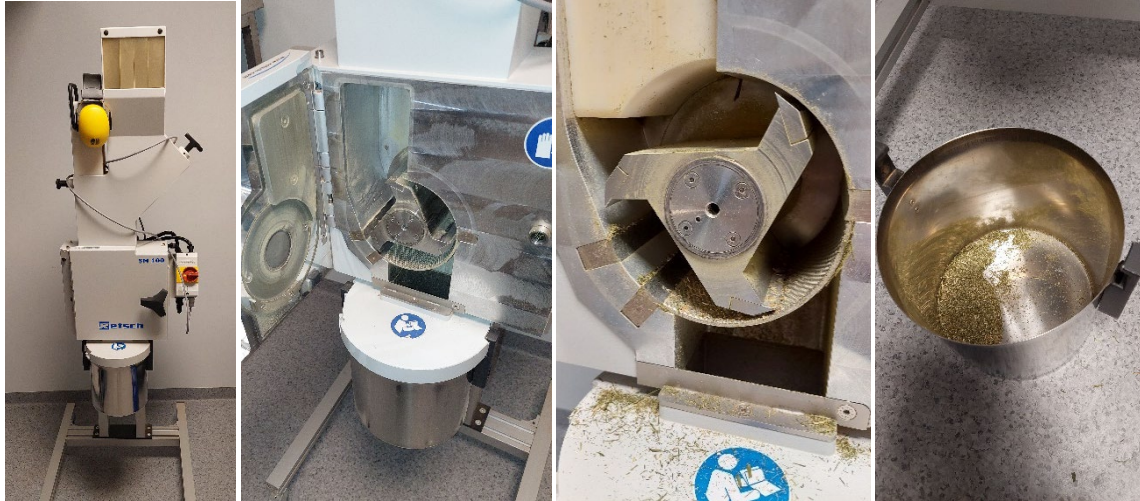
Figur 4. Bilder av Retsch SM 100 knivmølle. Foto: Nils Ragnar Stensø Skjørholm
