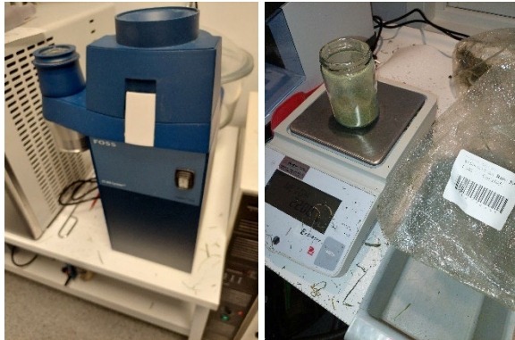
Figur 5. Foss Electronics Cyclotec 293 - sykklonmølle. Foto: Nils Ragnar Stensø Skjørholm
