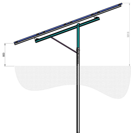
Figur 14: Bilde av solkraftverket som skal etableres i Sem solkraftverk. Solcellepanelene er montert på et stativ i sørlig retning. Bildet er hentet fra meldingen som ble sendt til NVE.
