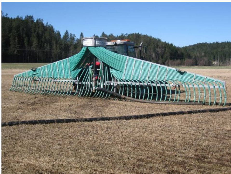
Figur 4: Slangespredning av husdyrgjødsel med stripespreder. Foto tatt av Jan Karstein Henriksen, Norsk Landbruksrådgiving. Henta fra https://www.agromiljo.no/slik-handterer-du-blautmokka-nar-gjodselprisen-oket/
