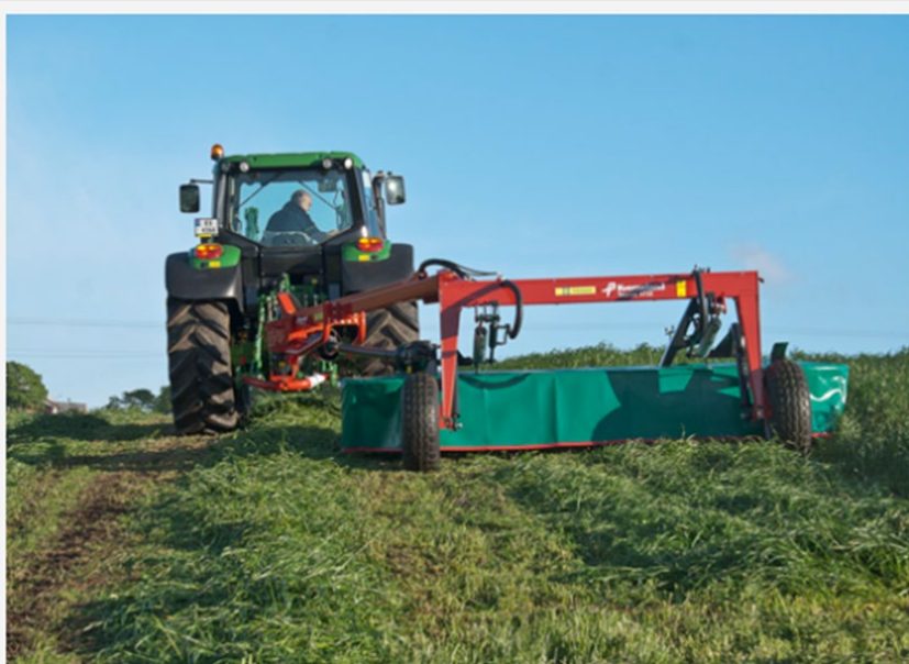
Slepeslåmaskin, Kverneland 4132. Arbeidsbredde, 3,20 m. Enkel slåmaskin med relativt stor kapasitet og lite effektbehov. Maskinen har ikke krimper (stengelknekker) og er derfor avhengig av at en raker sammen graset med rive. Med breispredning oppnår en god fortørrking. Enkel justering av stubbhøyde.
