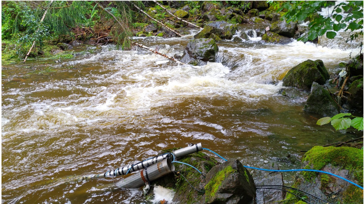
Målestasjon RUS2 med nitratsonde og multiparameter 09.08.23, rett etter HANS. Foto: Roger Roseth.
