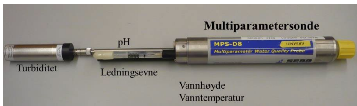
Figur 2.9. Multiparametersonde (MPS-D8) som er benyttet på stasjonen for kontinuerlige automatiske målinger.
