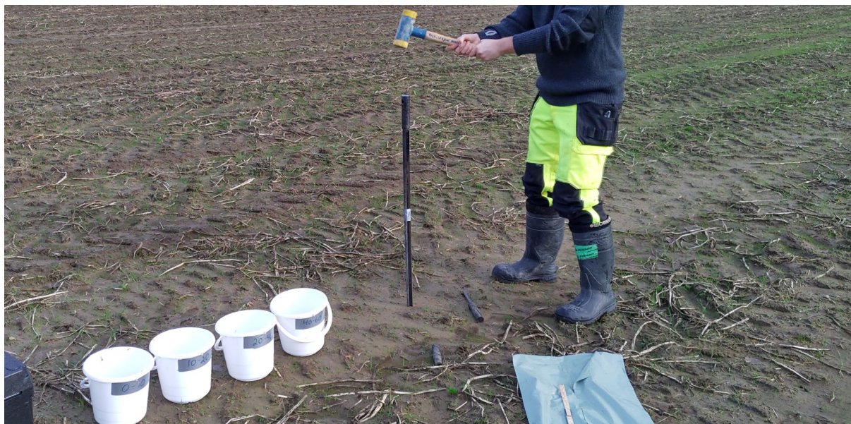
Figur 30. Uttak av jordsøyer for blandprøver fra ulike dybdelag, Rimstadmoen 02.11.21 (Foto: Roger Roseth)
