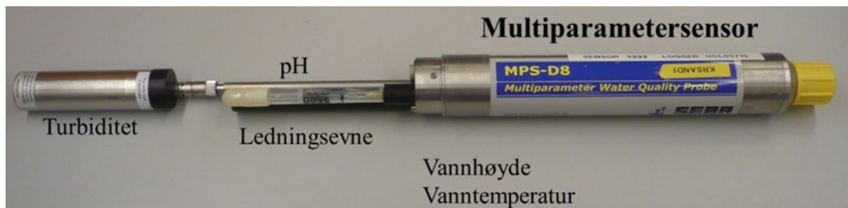
Figur 3-1. Multiparametersensor for kontinuerlig overvåking av vannkvalitet.
