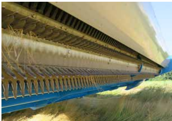
Bilde 1. Ribbeskjærebordet består av åtte rader med strippende fingre som slår frøet ut av akset eller frøhodet når akselen roterer. Foto: Lars T. Havstad
