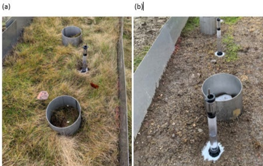
Figur 15: Infiltrasjonsforsøk: (a) Beerkan infiltrasjonstest; (b) «tension disk» infiltrometer.
