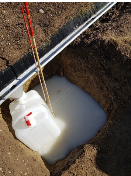
Figur 6: Det meste av vannet lekket ut via åpne makroporer i jordprofilen, langs leirlaget ved 30 cm eller via drensrørene. Grøftene ble fylt opp av plantevernmidelløsning og måtte lenses fortløpende. Prøver måtte tas direkte fra grøftene.
