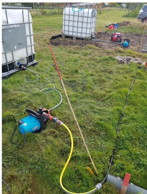
Figur 4: Vanntankene ble koplet til en pumpe og videre til dyseslanger som fordelte vannet inn i vegetasjonssonene med en rate på ca. 3 liter/minutt. Slangene som ble benyttet var standard Gardena hageslanger (½", d=13 mm) med koplinger og overganger.
