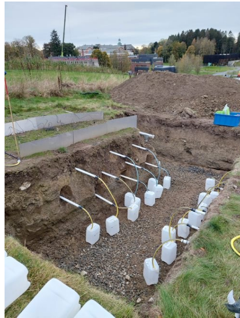
Figur 8: Venstre: Utgraving av grøfter langs og foran gravemaskin. Høyre: Oppsamlingsrør installert horisontalt inn fra sidene på forsøksrutene for å samle opp vann som infiltrerte ned gjennom jordprofilen.
