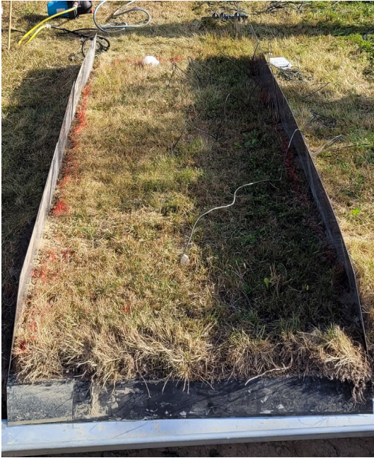
Figur 17. Ut plassering av sensorer for måling av vanninnhold i en av forsøksrutene i 2022.
